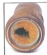
Verkalktes Kupferrohr im Warmwasserbereich
