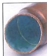
Kupferablösungen im Kaltwasserbereich
