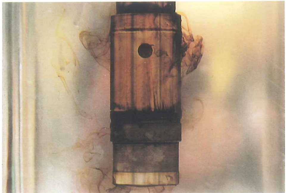
Entfetten von Stahlwellen im Tauchverfahren mit TECHSAN EXTRA.
